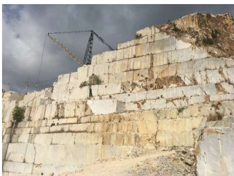
รูปที่ 2-7: หน้าเหมืองแบบขั้นบันได
